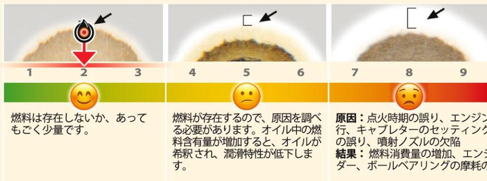
リングやピストンの摩耗により、未燃焼の燃料がエンジンに混入しています。
